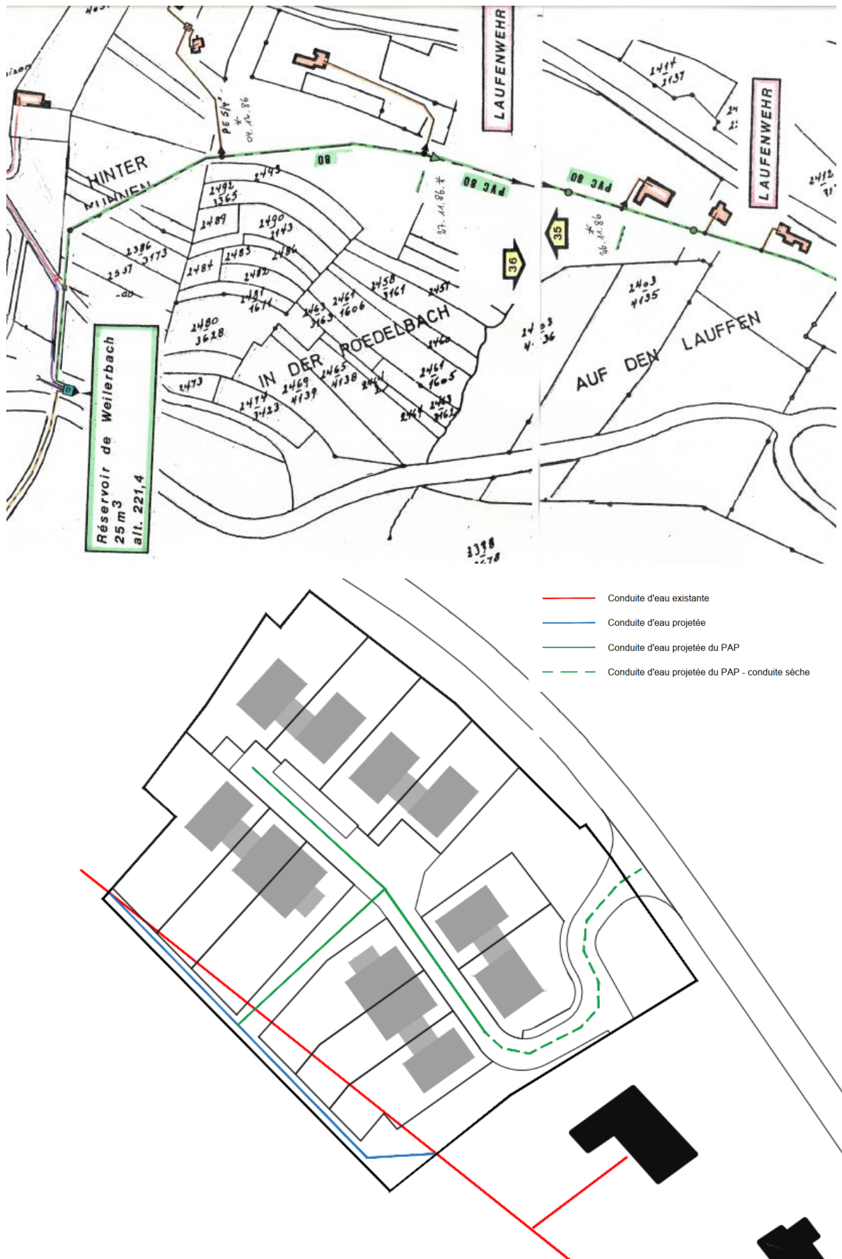
Figure 19 : extrait du plan réseau « Eau potable » et proposition de réorganisation
